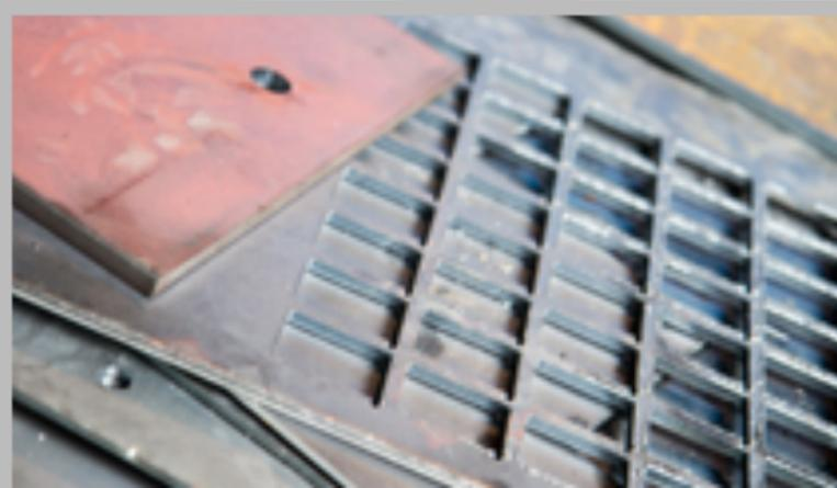
gleichzeitiges Schneiden und Markieren
